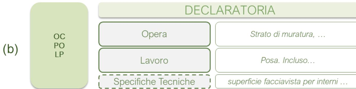
OPERA: Strato di muratura, blocchi tipo "svizzero" di ceramica terracotta/laterizio; funzione: portante; spessore [cm] = 30. Incluso: spalle, voltini, spigoli, lesene.
