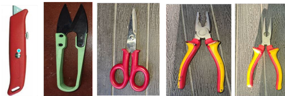
Figure 37 - esempio di utensili per il prelievo di campioni di natura fibrosa o filamentosa
