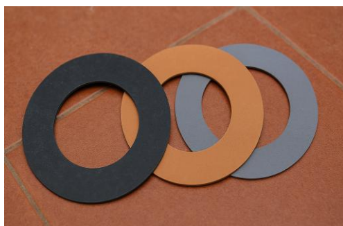
Figura 13 - guarnizioni in fibre di amianto
