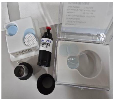
Figure 48 - supporto e membrana/ filtro di prelievo
