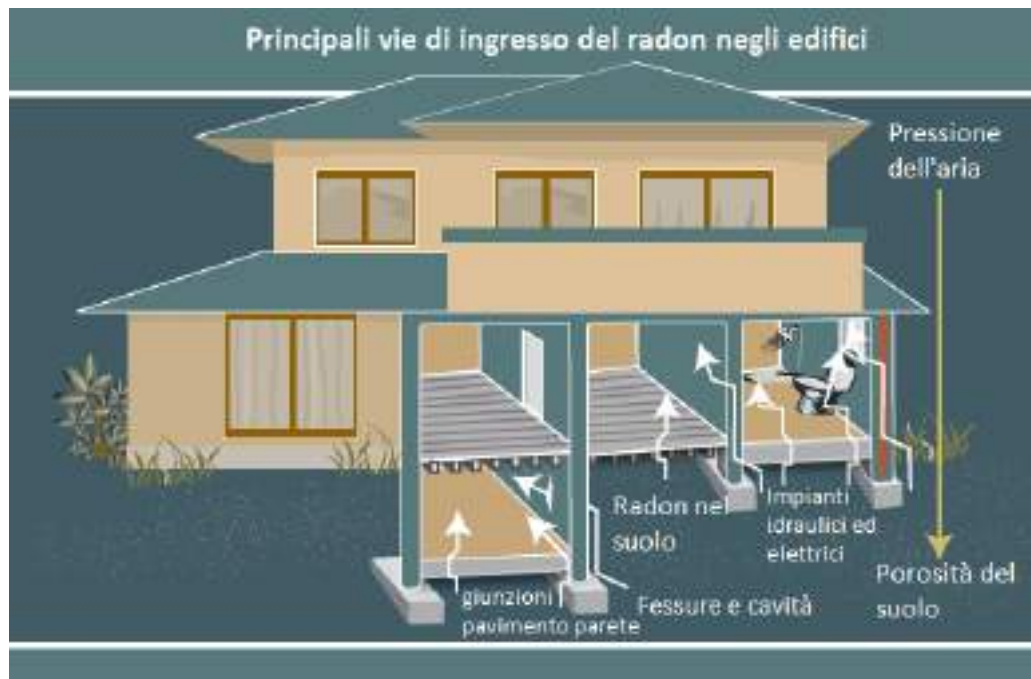
Figura 4: Principali vie di ingresso del radon negli edifici [5]
