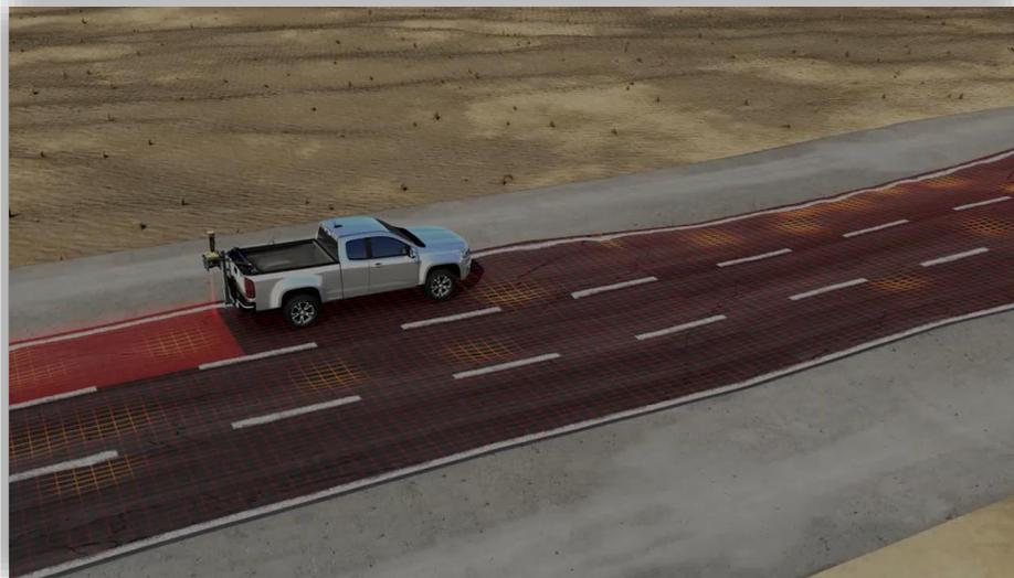
Lo scanner RD-M1 permette di creare tramite una scansione, la nuvola di punti ed il DTM della superficie stradale esistente
