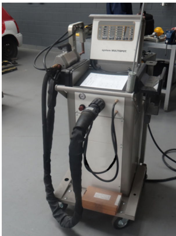
Figura 6.2 — Tipica saldatrice a punti manuale da carrozziere. Il sistema è mobile, con un'unità di controllo su ruote orientabili. I cavi di alimentazione elettrica e di raffreddamento escono dalla parte anteriore dell'unità e si inseriscono nella parte posteriore della pistola per saldatura, che è collocata nel suo sostegno alla sinistra del pannello di controllo
