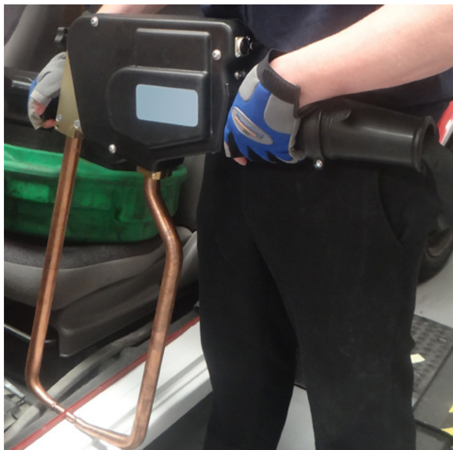
Figura 6.5 — Pistola per saldatura da carrozziere «tipo X» recante gli elettrodi da 550 mm. I due elettrodi sono spinti l'uno contro l'altro, come nell'azione di una pinza, da un pistone situato nel corpo principale della pistola (tra le mani del lavoratore), che contiene anche il trasformatore da cui proviene la corrente di saldatura
