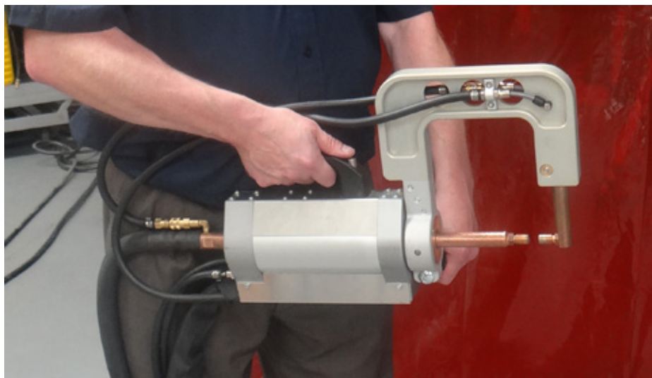
Figura 6.4 — Pistola per saldatura da carrozziere «tipo C» recante il braccio da 160 mm. Il corpo principale della pistola (sotto la mano del lavoratore) contiene il pistone che spinge un elettrodo sull'altro. La corrente di saldatura viene trasmessa dall'unità di controllo tramite i cavi alla sinistra dell'illustrazione
